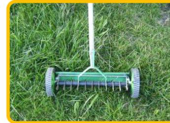
**Escarificador de césped. Escarificar consiste en rasgar superficialmente el suelo para eliminar el fieltro o capa impermeable de restos vegetales que se genera habitualmente en el césped, perjudicando su crecimiento.**
