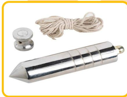
**Plomada.** Consiste en un peso atado a un cordel o a un alambre y sirve para señalar la verticalidad de cualquier elemento. Es de gran ayuda para comprobar que una pared está perfectamente vertical.
