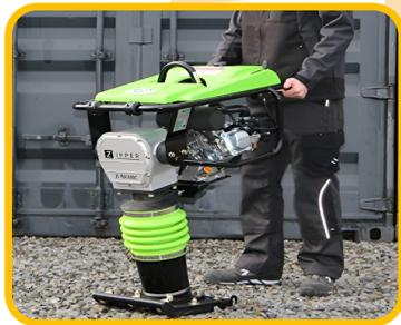
El pisón compactador, también llamado comúnmente rana, es una máquina compuesta por un brazo y una bandeja vibratoria que compacta el terreno. Un motor hace vibrar la bandeja, la cual ejerce una fuerza de presión sobre el terreno.
